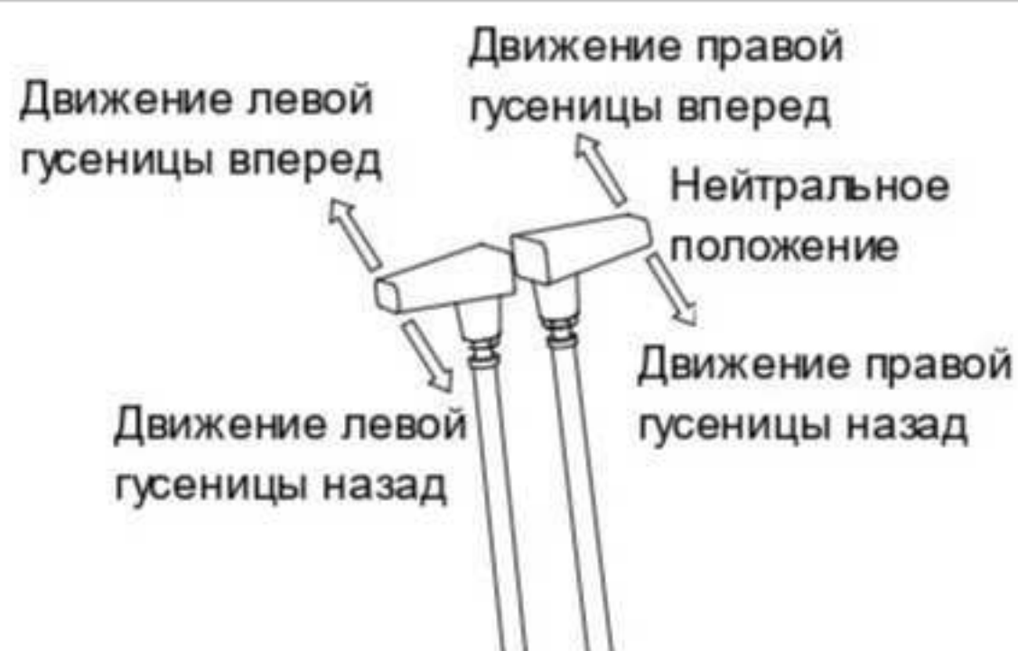
Рисунок 4-27 Рычаги управления механизмом передвижения
